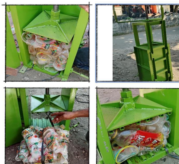
Gambar 3. Implementasi mesin press plastik pada bank Sampah Sinar Berlian
